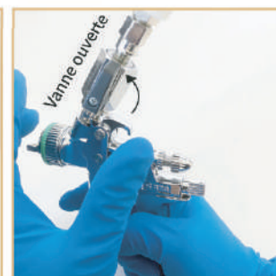
5 - Votre godet est installé, ouvrez la vanne du godet en effectuant un quart de tour, vous pouvez pulvériser vos entremets.
