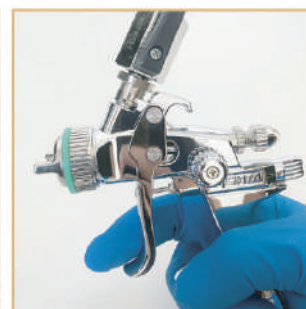
5 - Votre godet est installé, ouvrez la vanne du godet en effectuant un quart de tour, vous pouvez pulvériser vos entremets.
