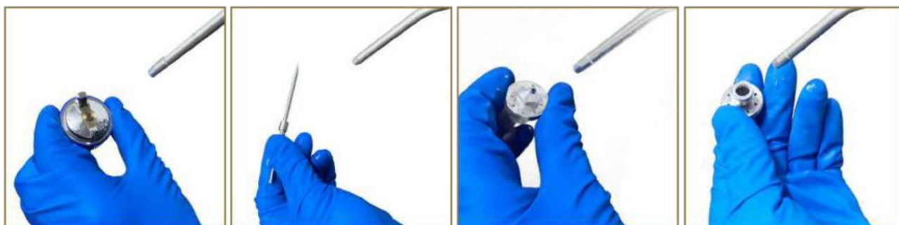
16 - Séchage de l'aiguille.
