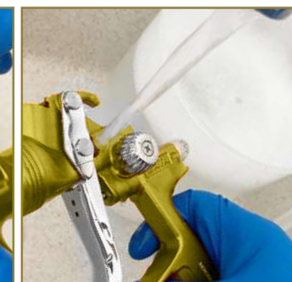
14 - Rincez à l'eau claire le corps du pistolet et le canal de peinture.
