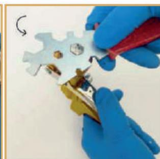
4 - Enfin, la buse de produit sera dévissée à l'aide de la clé intégrée dans l'outil universel.
