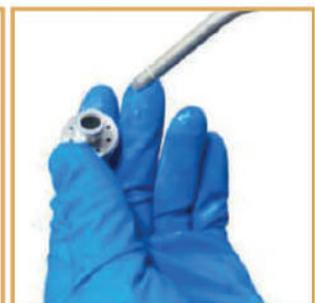
Lors du nettoyage des composants du kit projecteur, s'assurer que les pièces métalliques des brosses, n'endommagent pas le kit projecteur. Préférez les pinces et les brosses de nettoyage fabriqués spécialement par SATA et les aiguilles de nettoyage de buses SATA afin de garantir un entretien et un nettoyage parfait du kit projecteur.
