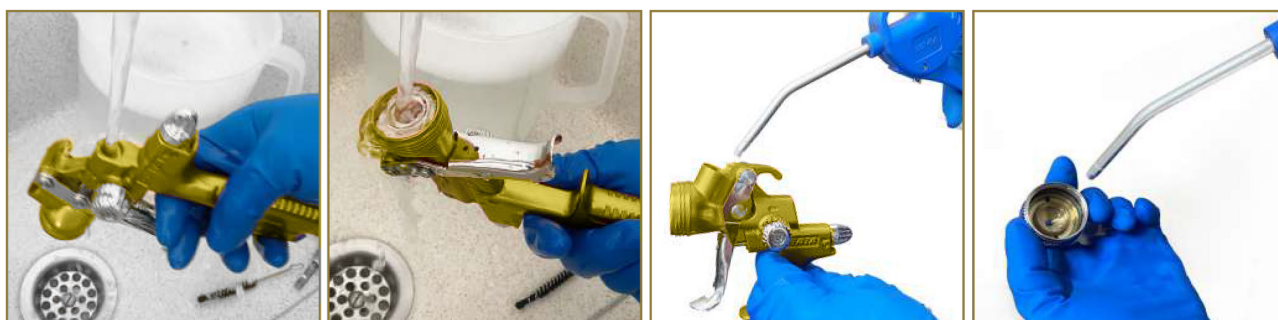
14 - Rincez à l'eau claire le corps du pistolet et le canal.
