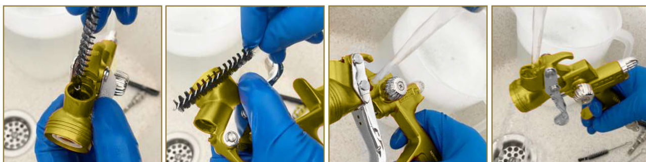
12 - Nettoyer avec les goupillons le corps du pistolet et le canal de peinture.
