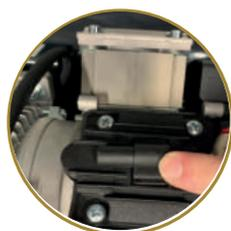
Dévisser à l'aide d'un tournevis cruciforme le capot de protection du filtre à air
