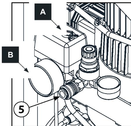
Pendant le fonctionnement, lorsque la pression de service maximale d'air est atteinte (8 bar), le pressostat coupe automatiquement l'appareil.
